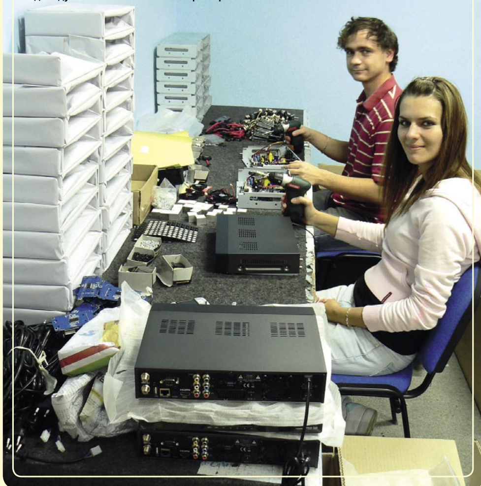
■ Перспектива помещения в сборочном цехе: именно здесь детали и компоненты, поставляемые из-за границы, превращаются 16-ю служащими в приемники АВ-COM, пока каждый приёмник АВ-COM не будет проверен индивидуально на соответствие характеристикам.
