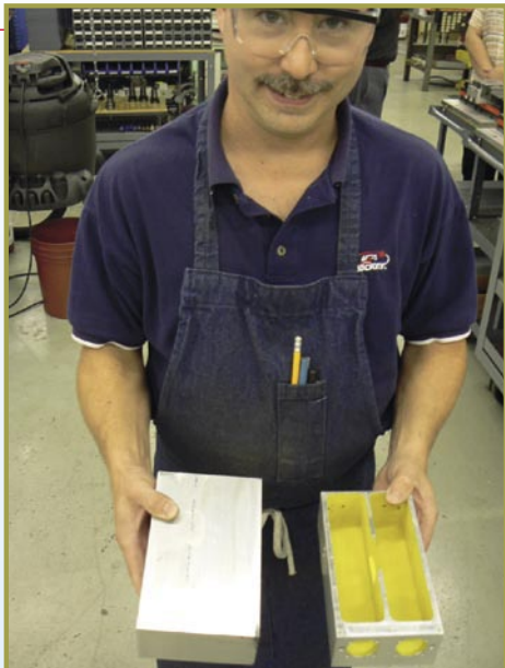
■ Dale Newton nous montre la séquence de production : à partir d'un bloc plein de l'aluminium (à gauche) un corps de filtre complet est fraisé avec toutes les ouvertures pour des connecteurs et des vis (à droite).
