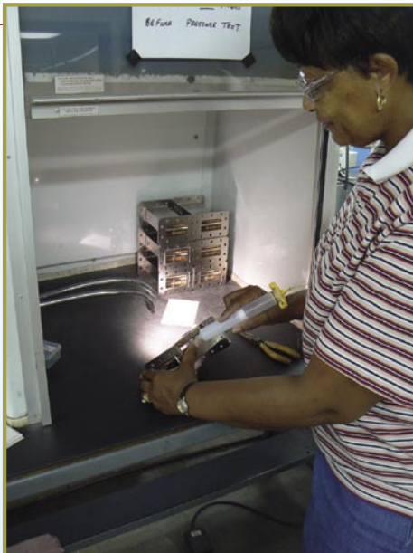
■ La sonde de réception dans le filtre est mise en place par Vertell Brantley. La colle qui est utilisée doit sécher pendant trois heures ; les filtres sont stockés dans cette chambre protégée de l'air environnant. Ensuite, les filtres sont fixés avec un joint étanche.
