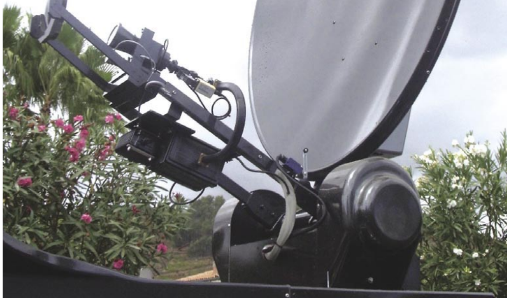
La parabole de 150 cm est motorisée et s'ouvre d'elle-même pour localiser le satellite automatiquement.
