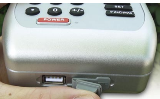
Interface USB pour relier le mesureur au PC située à côté de la prise pour l'alimentation.
