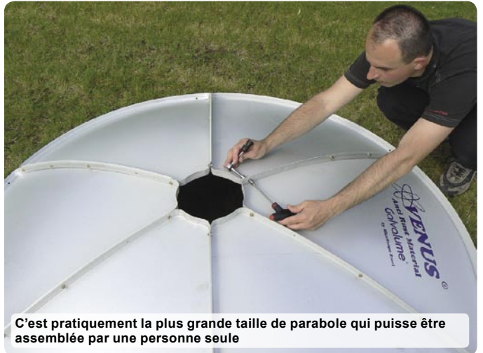
Les bords des segments sont repliés vers l'arrière pour améliorer la solidité
