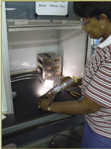
■ Das Empfangsteil des Filters wird von Vertell Brantley in Position gebracht. Sie verwendet dazu speziellen Kleber, der drei Stunden trocknen muss. Während dieser Zeit lagern die Filter in einer Schutzkammer und kommen so nicht mit der Umgebungsluft in Berührung. Im nächsten Schritt werden sie dann mit einer wetterfesten Schutzschicht versiegelt.
