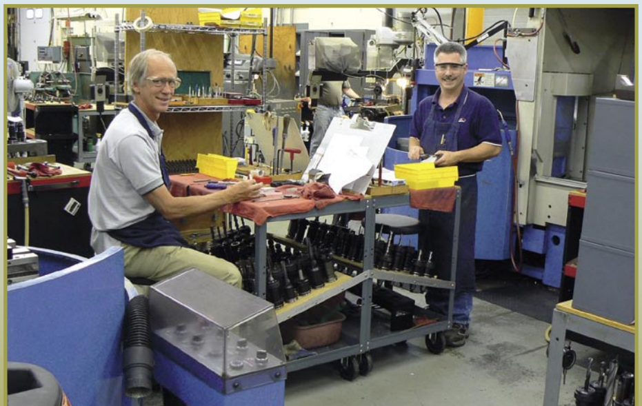
■ An der Metallfräse mit Bruce Sentoff (links) und Dale Newton (rechts). Die Gehäuse vieler Filtertypen werden hier aus soliden Metallblöcken gefräst. „Wir programmieren dazu die Maschinen am Abend und lassen diese dann über Nacht die Arbeit erledigen“, erklärt Bruce Sentoff.
