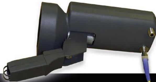
So sieht der Prototyp der Anschlußdose (Wall Plate) aus: vorne der Eingang des Lichtwellenleiters, hinten Anschluß für das handelsübliche Koaxkabel zum Receiver. Wie man erkennt, benötigt die Anschlußdose eine Spannungsversorgung. Im realen Betrieb später wird die Anschlußdose die Betriebsspannung über den LNB-Eingang vom Satellitenreceiver entnehmen.
