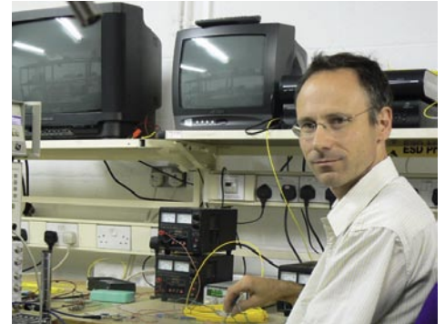
Michael überprüft die Prototypen in der Praxis. Hier sehen wir einen Versuchsaufbau: ein künstlich erzeugtes Satellitensignal gelangt über eine 30m lange Lichtwellenleitung an einen Umsetzer. Mit einer Prüfspitze verfolgt Michael an den Meßgeräten, ob die Ursprungssignale innerhalb der Toleranzen eintreffen.
