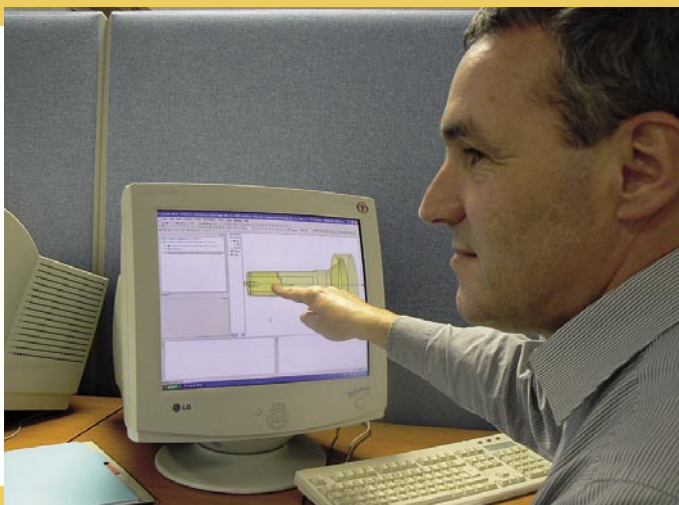
▲ Wie testet man ein LNB-Konzept? Heute geschieht auch dies elektronisch. Chris Timmins zeigt uns hier auf dem Bildschirm die Software „HF Structure Simulator“: sie simuliert das Verhalten des LNB und des Feed. Chris ist dabei, den Polarizer eines LNB-Modells zu optimieren. Er verändert einige Parameter, und simuliert dann ein Satellitensignal, um zu sehen, ob es eine Verbesserung gab.
