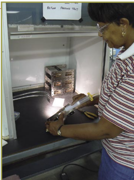
■ Приемащата проба във филтъра се поставя на място от Vertell Brantley. Лепилото, което се използва трябва да се остави да се втвърди за около три часа; филтрите се съхраняват в тази камера от околния въздух, след което се фиксират с водоустойчиво покритие.
