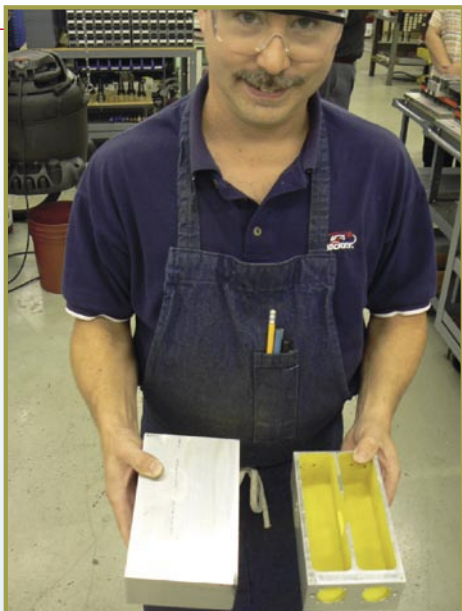
■ Dale Newton ни показва производствения процес: от големите алуминиеви блокове (отляво) се правят филтърните тела заедно с всички отвори за конекторите и винтовете (отдясно).
