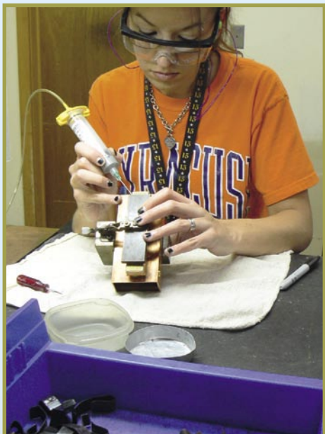
■ Тук филтъра се сглобява механично. Служителката на MFC Melissa Bench го приготвя за запояване в горещата печка...
