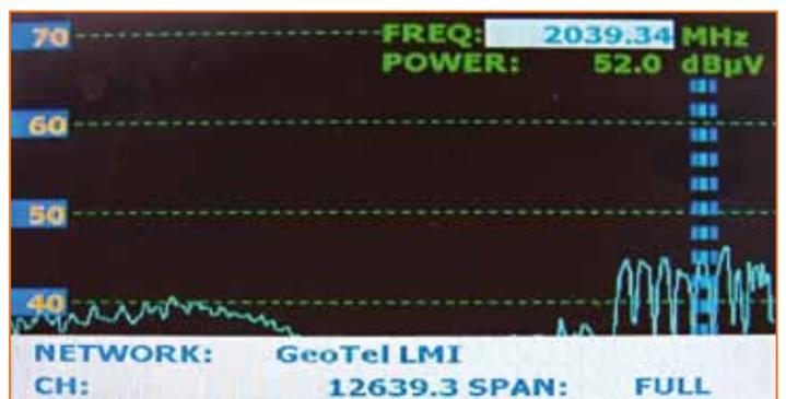
Espectro del ABS1 75° Este con un LNB coaxial |
