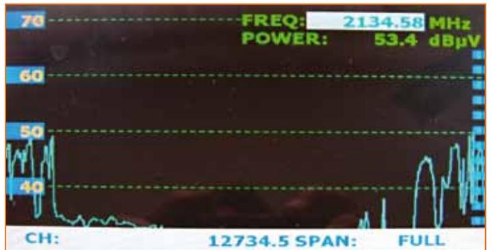
Espectro del NSS7 22° Oeste con un LNB coaxial |
