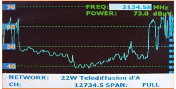
Espectro del NSS7 22° Oeste con el LNB de Invacom |
