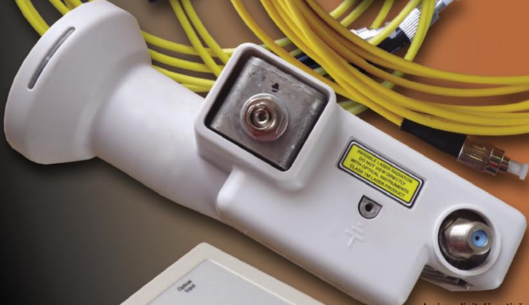
leşirea digitală optică și mufa F pentru alimentarea cu curentul electric necesar LNB-ului optic
