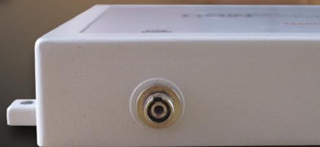
Wejście optycznego sygnału optycznego w GTU
