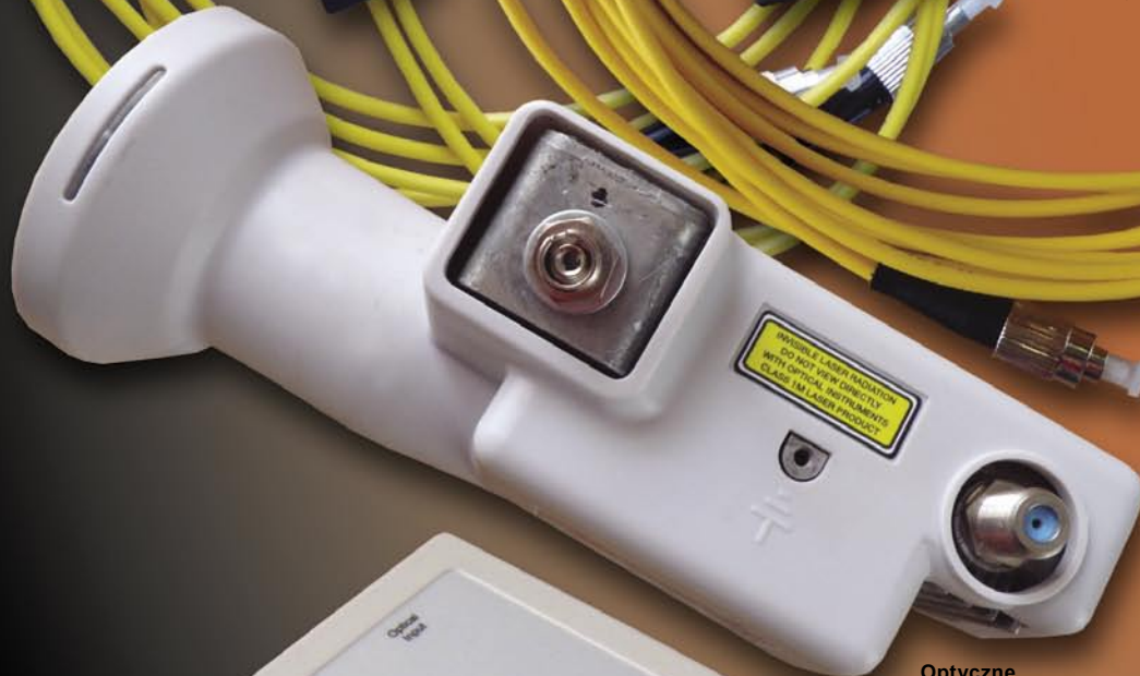
Optyczne wyjście sygnału cyfrowego i złącze F do podłączenia zasilania
