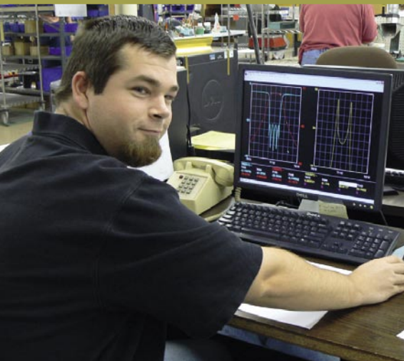
Eric Logan, mühendis ekibinden. Filtre tasarımlarını müşteri taleplerine göre, doğrudan bilgisayardan değiştirebiliyor. MFC, askeri amaçlı pek çok filtre de üretiyor. (örneği X-bant)
