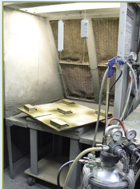
■ MFC gör nästan allting själv: De färdiga filtren sprayas här med ett skyddande lager färg.
