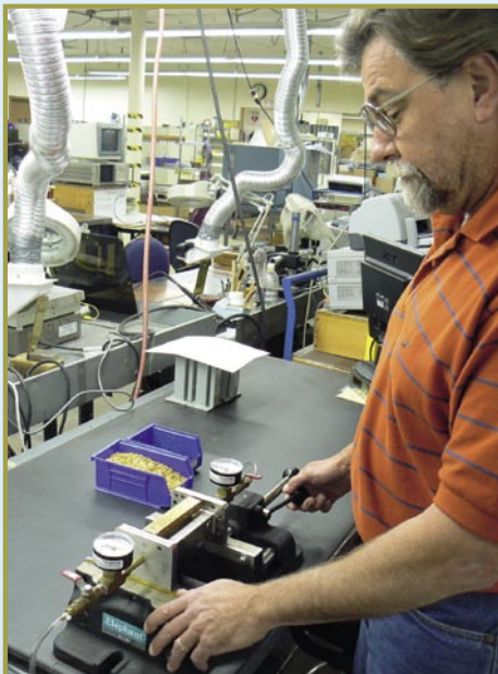
■ Bill Adamo è il Quality Control Group Leader e ci mostra come la chiusura ermetica di un filtro venga testato sotto pressione: "Il filtro viene posizionato qui e pressurizzato con aria a 5 PSI." In questo modo possono verificare se l'interno del connettore, come anche la sua montatura nell'alloggiamento sono resistenti all'aria. "La più piccola fessura può permettere il formarsi dell'umidità a lungo andare e può alterare le caratteristiche del filtro", dice Bill Adamo, "Noi testiamo il 100% dei nostri filtri!" Ogni cliente può essere certo che ogni e qualsiasi filtro MFC è all'altezza delle sue specifiche di alta qualità.
