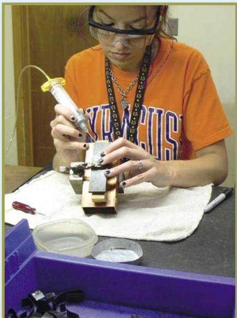
■ Qui un filtro viene assemblato meccanicamente. L'impiegata di MFC Melissa Bench prepara un filtro per il forno di saldatura...
