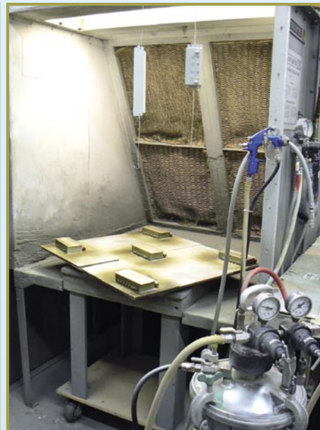
■ MFC fa virtualmente tutto da sé: i filtri completi qui vengono spruzzati con una strato protettivo colorato.
