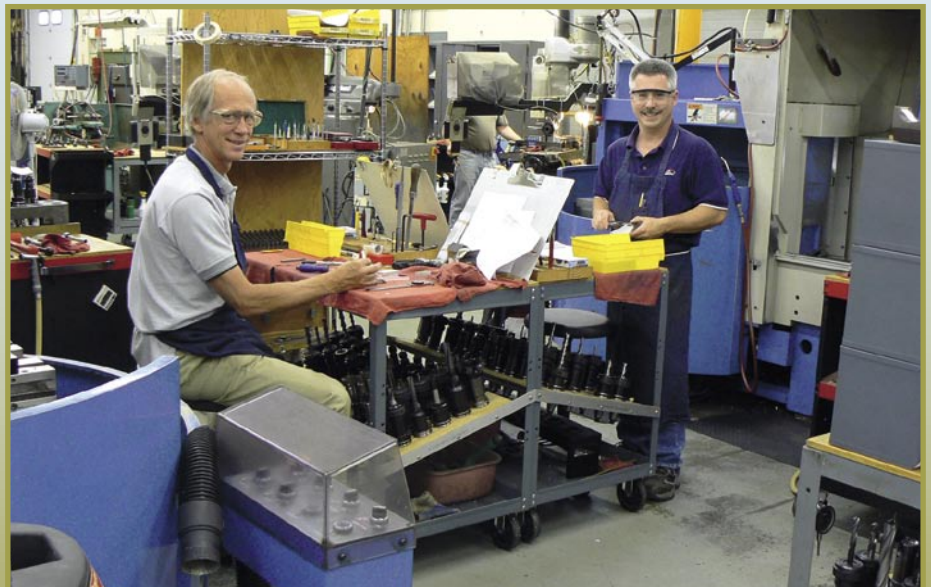
■ Na CNC stroju uz Brucea Sentoffa (lijevo) i Dalea Newtona (desno). Ovdje se od čvrstih metalnih blokova prave kućišta velikog broja modela filtera. „Navečer programiramo strojeve, a one tijekom noći obavljaju posao”, objašnjava Bruce Sentoff.
