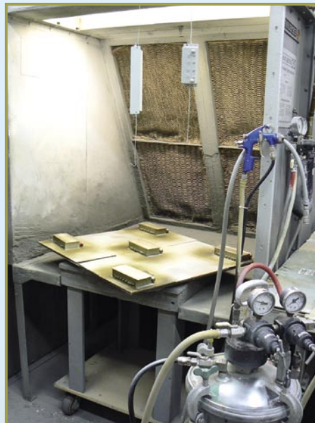
■ MFC doslovno sve korake proizvodnje obavlja sam: dovršeni filteri ovdje se prskaju zaštitnim lakom u boji.
