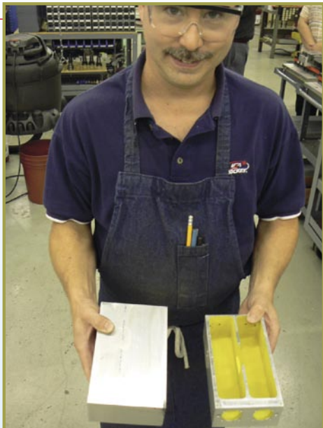
■ "دیل نیوتون" مراحل تولید را به ما نشان می دهد: بدنه کامل یک فیلتر با تمامی ورودیهای کانکتورها و پیچها (راست) از یک بلوک آلومینیم (چپ) تراشیده می شود.
