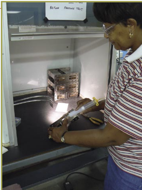
■ پررب دریافت توسط "ورتل برانتلی" جایگذاری می گردد. چسبی که به کار برده می شود می بایست برای مدت سه ساعت خشک شود. فیلترها برای حفاظت از هوای محیط در این اتاقک نگهداری می شوند. سپس فیلترها در لفافی که از نفوذ هوا جلوگیری می کند، بسته بندی می شوند.
