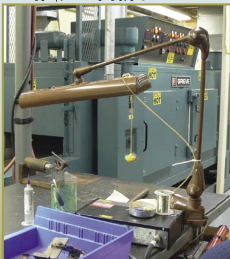
■ ... عملیات لحیم کاری اصلی در این گرمخانه که فیلترها از آن عبور می کنند، انجام می شود.
