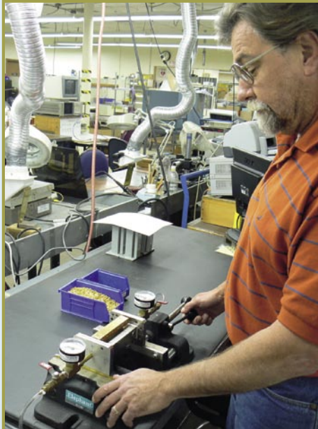
■ Bill Adamo ist Chef der Qualitätskontrolle und zeigt uns, wie das wetterfeste Gehäuse des Filters überprüft wird: „Der Filter wird in das Gerät gespannt und 5 PSI Luftdruck ausgesetzt.“ Auf diese Weise kann festgestellt werden, ob die Anschlüsse, ebenso wie das Gehäuse, luftdicht sind. „Schon das kleinste Leck kann im Lauf der Zeit Feuchtigkeit eindringen lassen und somit die Eigenschaften des Filters verändern“, sagt Bill Adamo, „deshalb testen wir 100% unserer Filter!“. Somit kann jeder Kunde sicher sein, dass alle MFC Filter genau ihren hochqualitativen Spezifikationen entsprechen.
