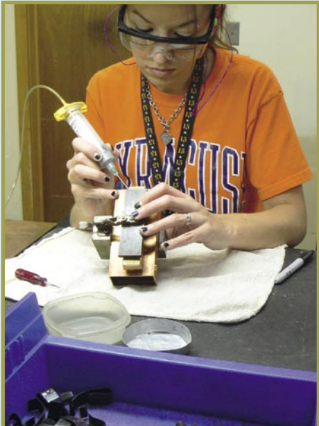
■ Hier wird gerade ein Filter mechanisch zusammengesetzt. Die MFC Angestellte Melissa Bench bereitet ihn für den Lötöfen vor.
