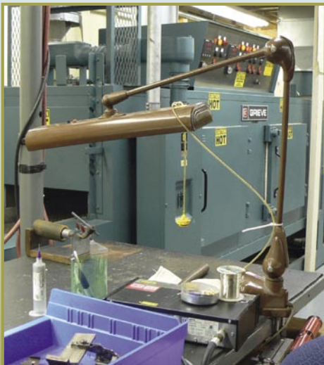
■ Der eigentliche Lötprozess findet in diesem Lötöfen statt, den die Filter im Zuge der Produktion durchlaufen.
