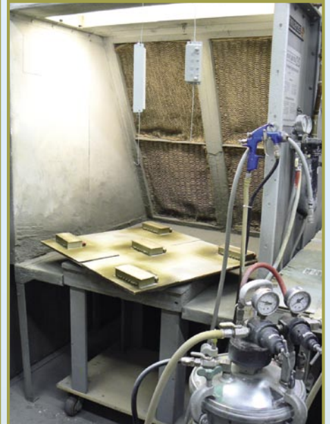
■ MFC führt wirklich alle Produktionsschritte selbst aus. Hier werden die fertigen Filter mit einem farbigen Schutzlack versehen.
