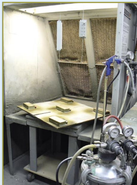
■ V MFC si v podstatě dělají vše sami: smontované filtry jsou zde nalakovány sprejem s ochranným lakem.
