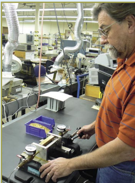
■ Bill Adamo je vedoucím kontroly kvality a ukazuje nám, jak je odolný kryt filtru testován pod tlakem: „Zde umístíme filtr a stlačíme jej tlakem vzduchu 5 PSI.“ Tímto způsobem mohou zjistit, zda je vnitřek konektoru a zabudování do krytu zcela vzduchotěsné. „I nepatrná netěsnost může průběhem času umožnit vnik vlhkosti a změnit tak charakteristiku filtru,“ říká Bill Adamo. „Testujeme 100 procent našich filtrů!“ Každý zákazník si může být jistý, že všechny filtry MFC bude fungovat dle jeho špičkových specifik.
