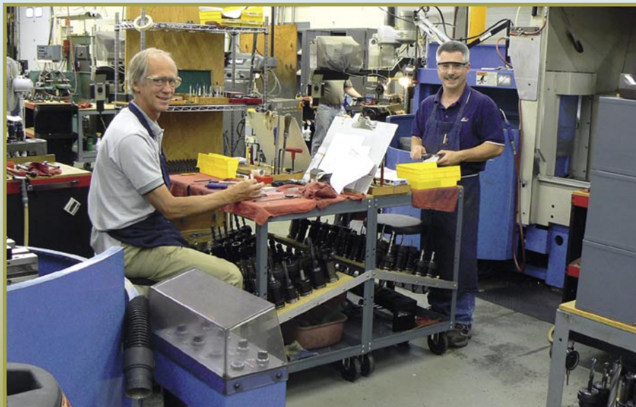
■ U CNC frézy s Bruce Sentoffem (vlevo) a Dalem Newtonem (vpravo). Tělesa mnoha filtrů se vyrábějí zde z větších bloků. „Stroje programujeme každý večer a ony pak běží přes noc automaticky,“ vysvětluje Bruce Sentoff.
