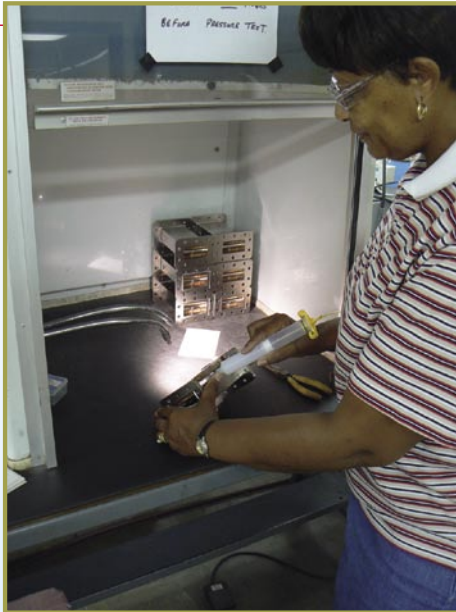
■ Pencari penerimaan dalam filter dipasang oleh Vertell Brantley. Lem yang digunakan perlu diset untuk tiga jam; filter diletakkan dalam peti ini untuk melindunginya dari udara luar. Selanjutnya, filter dipasangi segel kedap udara.
