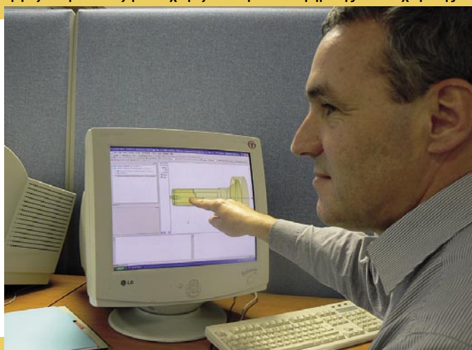
▲ Πως δοκιμάζεται την ιδέα σας για ένα LNB; Σήμερα, αυτό γίνεται ηλεκτρονικά. Ο Κρις Τίμινς μας παρουσιάζει το λογισμικό "HF Structure Simulator": προσομοιώνει την συμπεριφορά ενός LNB και της τροφοδοσίας του. Ρυθμίζει μερικές παραμέτρους, προσομοιώνει ένα δορυφορικό σήμα και ελέγχει εάν υπάρχει κάποια βελτίωση.
