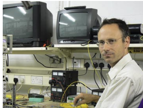
Ο Μάικ ελέγχει τα πρωτότυπα. Εδώ μπορούμε να δούμε ένα δοκιμαστικό προϊόν: ένα τεχνικά παραγόμενο δορυφορικό σήμα αποστέλλεται με ένα καλώδιο οπτικών ινών σε έναν μετατροπέα. Χρησιμοποιεί μια ελεγκτική διάταξη για να προσδιορίσει εάν τα αρχικά σήματα φθάνουν στους αναλυτές μέσα στα επιθυμητά όρια.
