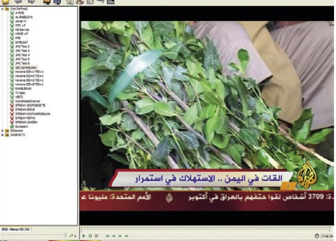
Con un codec apropiado y el software ProgDVB la Conect S2-3600 también puede desplegar transmisiones MPEG 4:2:2, por ejemplo un enlace de Al-Jazeera en NILESAT.
