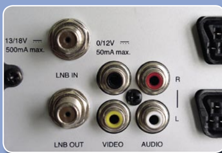
Colokan standar untuk LNB dan Audio
