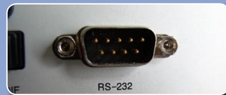
Dapat ditemukan pada kebanyakan receiver: colokan RS-232 untuk pemrograman melalui komputer
