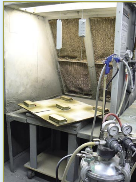
■ MFC właściwie robią wszystko sami: kompletne filtry są tutaj pokrywane aerozolowo ochronną farbą.
