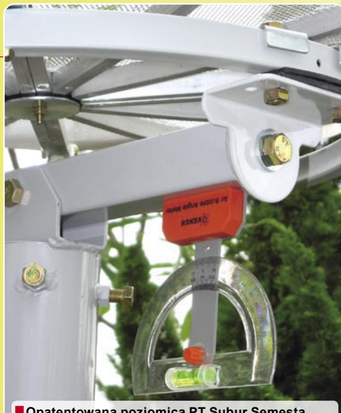
■ Opatentowana poziomica PT Subur Semesta czyni cuda podczas ustawiania anteny.
