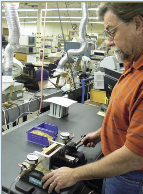
■ Bill Adamo jest Liderem Grupy Kontroli Jakości. Pokazuje nam jak sprawdza się ciśnieniowo szczelność filtra: „Filtr umieszczony jest tutaj i pompowany do ciśnienia 5 PSI.” W ten sposób sprawdza się czy wnętrze konektora i jego zamocowanie są szczelne. „Najmniejsza nieszczelność może pozwolić z czasem zgromadzić się wewnątrz wilgoci, co zmieniłoby charakterystykę filtra”, mówi Bill Adamo, „testujemy 100% naszych filtrów!” Każdy jeden klient może być pewien, że filtr MFC odpowiada najwyższym jakościowym specyfikacjom.
