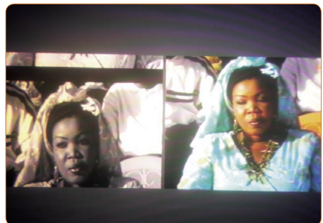
Tony jest w stanie testować dwa odbiorniki poprzez podzielenie wejścia wideo w telewizorze Sony. Na zdjęciu w lewej części ekranu widać sygnał PAL z odbiornika Quali HD. Prawa część sterowana jest z odbiornika FortecStar nastrojonego na ten sam kanał i używającego rozdzielacza LNB. Pozwala to sprawdzić czy sygnał PAL jest prawidłowo konwertowany z sygnału NTSC.
