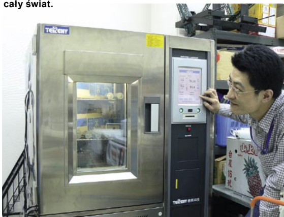
Próbki pobierane z linii produkcyjnej testowane są w komorach klimatycznych podgrzewających i schładzających. Tu ustawiane jest grzanie na 70°C. Testy prowadzi się w zakresie -40°...+90°C.
