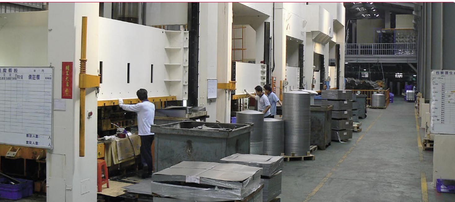
Prasy mechaniczne. Wstępnie przycięte arkusze metalu (na pierwszym planie na palecie) wkłada się pod prasy by po wytłoczeniu otrzymać antenę podświetlaną.
