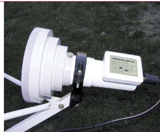
LNBF Acrotel ze stożkowym promiennikiem pierścieniowym na czaszy 1,0 m |
