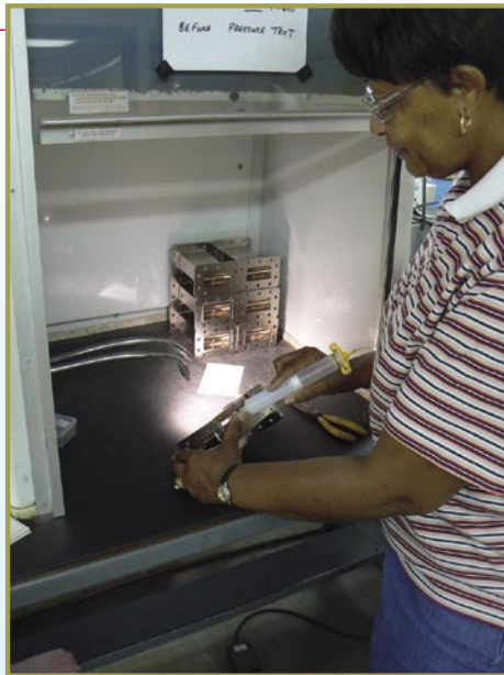
■ 沃泰尔·布兰特勒在安装滤波器的接收探针。使用的胶需要三小时才凝结；滤波器被安放在保护壳体之中。然后，过滤器就被密封起来，与周围空气隔绝了。
