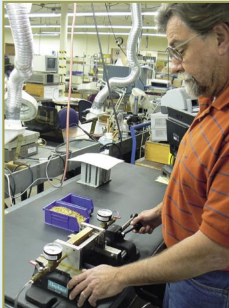
■ 比尔·阿达莫是质量管理小组的负责人，他向我们展示滤波器在进行密封压力测试：“这里的滤波器被放在 5 个大气压下。”这样，他们能检查到是否内部的连接器被完全密封。“即使是最小的渗漏也能让潮湿空气进去并改变滤波器的性能”，比尔·阿达莫说，“我们对滤波器进行 100% 的测试！”确保每个顾客的每个 MFC 滤波器都是优质的。
