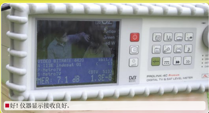
■安装完毕。现在要进行接收测试。
