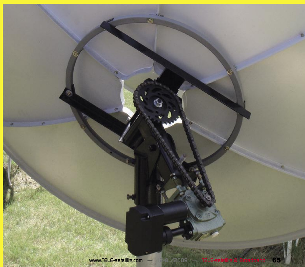
■ PT. Subur Semesta 公司生产的马达。它用链条将马达齿轮和天线极轴连起来。
