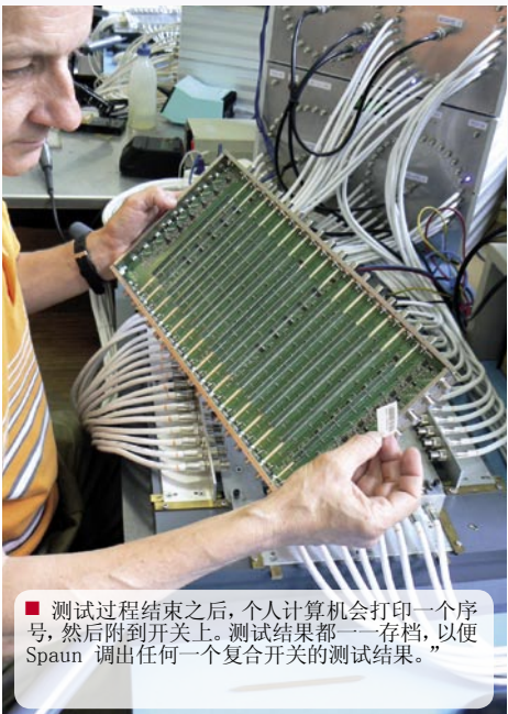
■ 每个复合开关都要进行多种功能的测试。复合开关放入测试台之内,当所有的“F”头都被插入后,测试程序才能开始。
