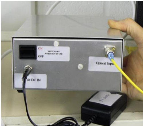
这是专用转换连接器：光缆从前面输入，背面连接到标准接收机上。如你所见，它需要供电。在今后的实际应用中，该专用转换连接器从卫星接收机的 LNB 输入端获得供电。
