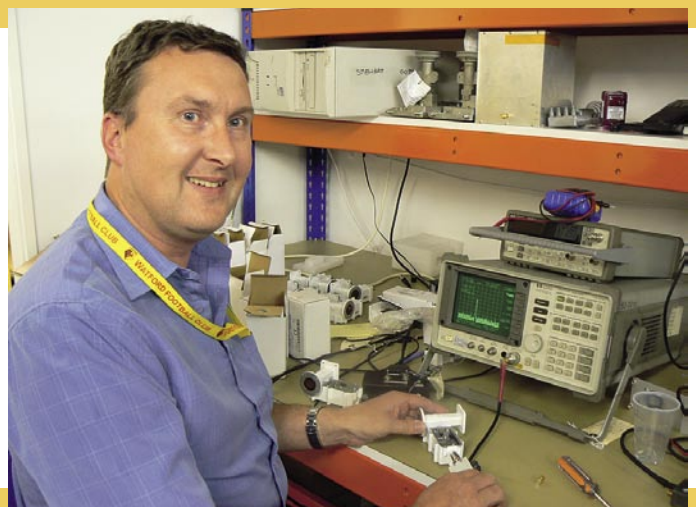
▲ INVACOM 公司的产品在严格监督之下由中国生产。由于有了 Skype 公司,今天成本已不在话下: INVACOM 公司每天早晨通过电话与制造厂研究当天的生产。一台互联网服务器一刻不停地传送生产数据使 INVACOM 完全掌控情况。而在现实世界中必须登记虚拟的产值。在这里,我们看见安迪·鲍特在检查最近送来 LNB 的 LOF: 一切正常, Spektrum 分析仪显示为 9.75 GHz, 再按下开关又显示为 10.6 GHz。干得漂亮!
