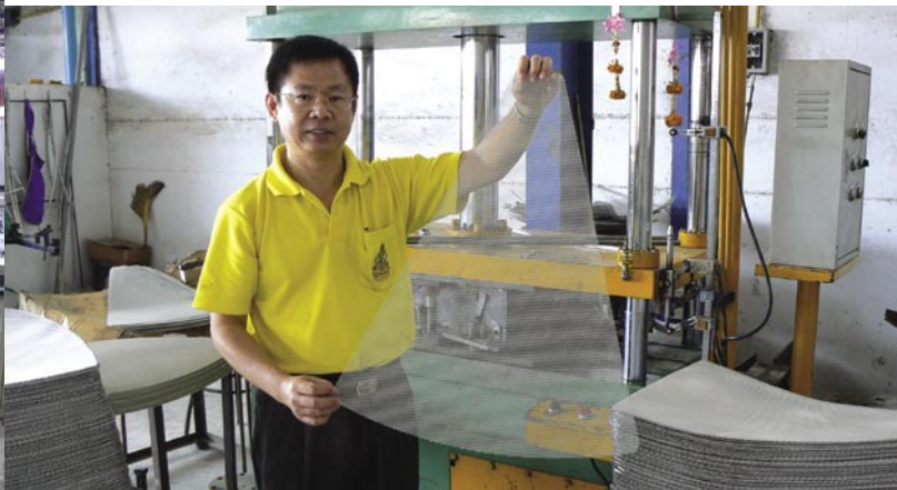
▲ 后面可以看见的压力机就是质量改进的原因之一：它将裁好的成形毛坯挤压成右面的抛物线形。此前，成形毛坯的加工是被放上一个镜架夹紧。由于在装运之前进行了修整，现在，抛物线形的精度增加了。
