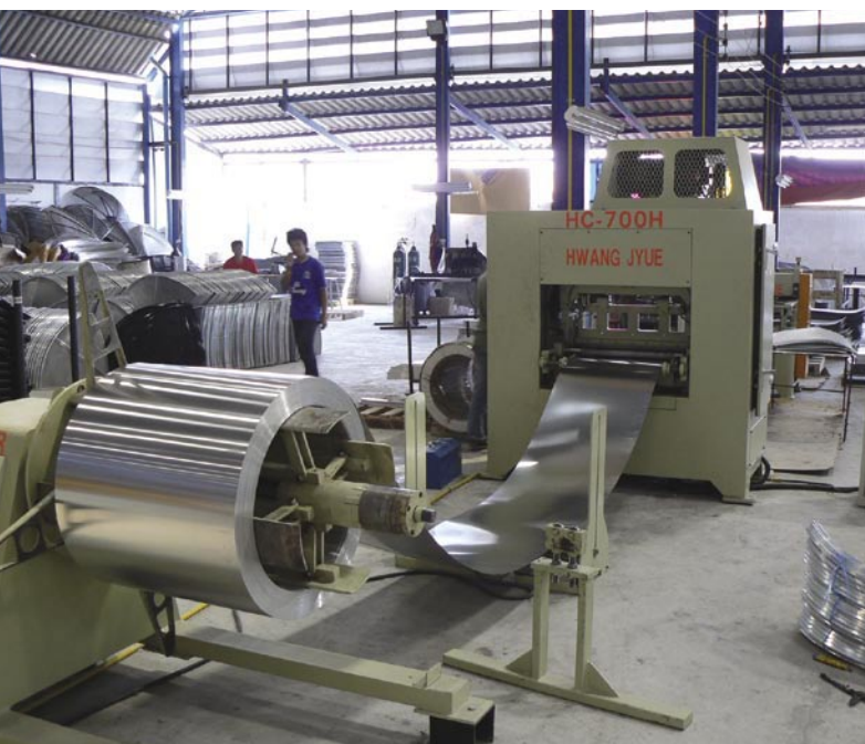
◀ 新在 INFOSAT：新冲床用来给铝板冲压出网眼。这样能在第一时间检查质量。
