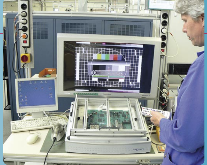
▲ 法兰克·莱曼是一名技术人员，负责检查主板。主板被连接到一个平板 LCD 电视测试台上，所有的天线都连接上，插电后用个标准遥控器测试每项功能。
