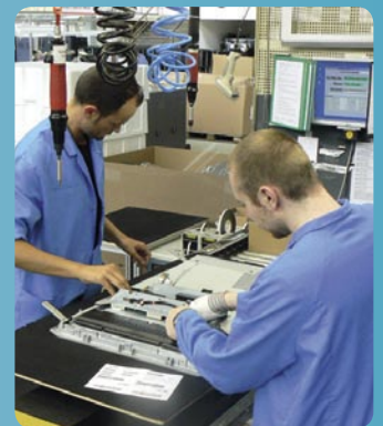
▲ 主板被放置液晶面板上面，并用螺丝固定保护好。
