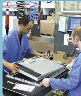
▲ 平板液晶面板到达后被放置在后方的托架上：这是在使它成为一个电视机的第一步。
