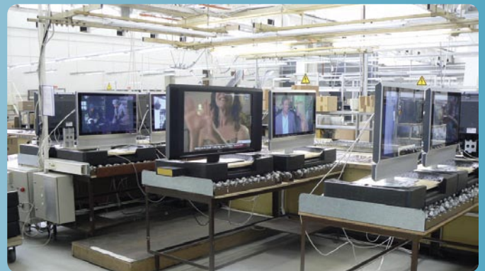
▲ 在安装完喇叭之后，平板 LCD 电视机准备好发运。有一些样品从生产线下下来要在这些测试台上进行一系列长时间测试。
