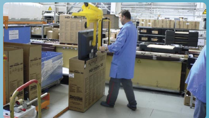
▲ 最后一步：起重机将产成品放入下面的盒子里面，搞定！
