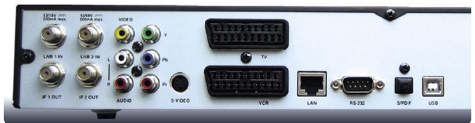
Topfield TF6000 PVRE 具有一个网络接口, 通过网络界面能够实现远程遥控。
