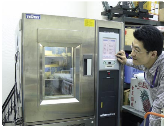
从生产线取来样本,放在热/冷环境室里进行测试,并被加热到70 °C。测试的温度为-40 °C到 +90 °C。
