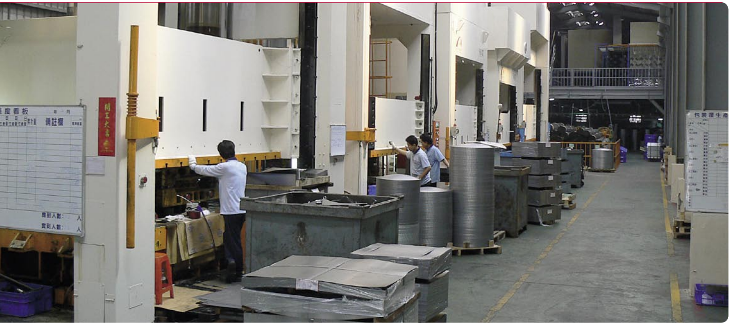
液压机：下好料的金属薄板（近处的一摞摞）被放在加工平台上，压力机上下一次便生产出一片偏馈天线面。
