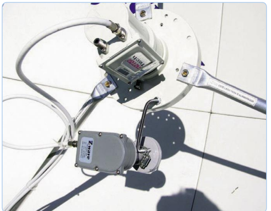
简单而有复杂：一根管子固定在另一个LNB的馈源盘上，这样足以接收BRASILSAT 3 ( 276^{\circ} E ) 和 NAHUEL 1A ( 288^{\circ} E )
