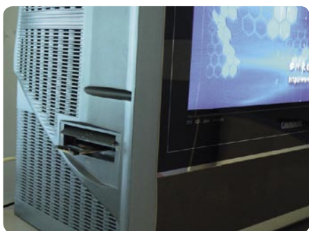
Smit公司CAM模块的一个应用实例：内置了卫星接收机的长虹宽屏电视机
