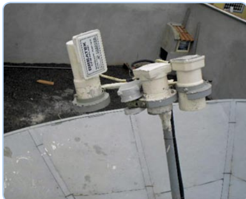
这种方法需要一些技巧：4个C波段馈源连接在一起
