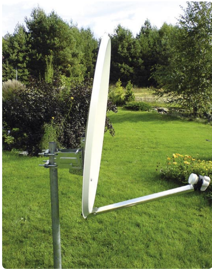
天线座非常适合它的仰角位置-现在所需要的就剩下把它转到正确的位置
