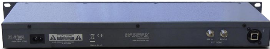
传输码流阅读器的背面, 带有另外一个高速USB接口, 还有天线接口。由Rod Hewitt的TSReader软件来处理
