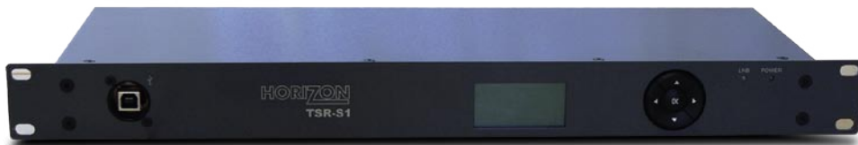
即将投放市场:一款19寸的传输码流阅读器, 面板左面带有USB程序接口
