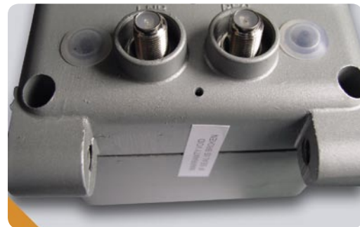
Jaeger马达的连接插座。要通过馈线发送控制脉冲到马达,马达必须安装在LNB和接收机之间。紧挨着F插座的是用来手动控制天线左右移动的按钮。
