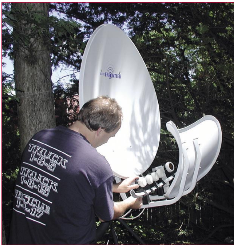
TELE-satellite 的编辑 Ron Roessel 正在纽约市郊的TELE-satellite 的测试中心调整 Wavefrontier Toroidal T90 天线上的馈源支架
