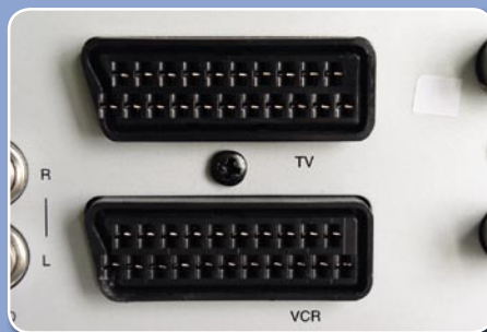
欧洲型接收机通用:连接电视机和录像机的二个 SCART 接口
