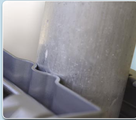
Marquage du Sud pour mieux aligner le moteur sur le mât
