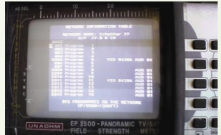
■ Le mesureur satellite de Diego montre les paramètres d'un des transpondeurs d'ECHOSTAR 6A qu'il reçoit
