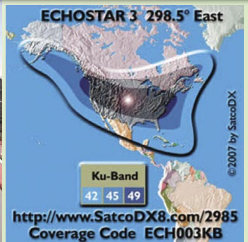
■ La zone de couverture est loin d'atteindre l'Europe - c'est du moins ce que nous dit la théorie. Dans le monde réel, la réception est très bien possible dans les limites occidentales de l'Europe
