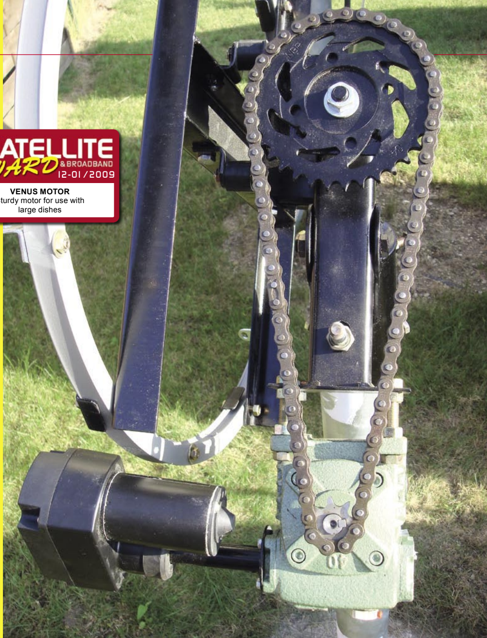
■ Le moteur de PT. Subur Semesta avec sa transmission à chaîne du boîtier de démultiplication à l'axe
