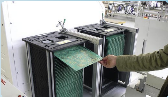
▲ La platine principale arrive prête à recevoir les composants.
