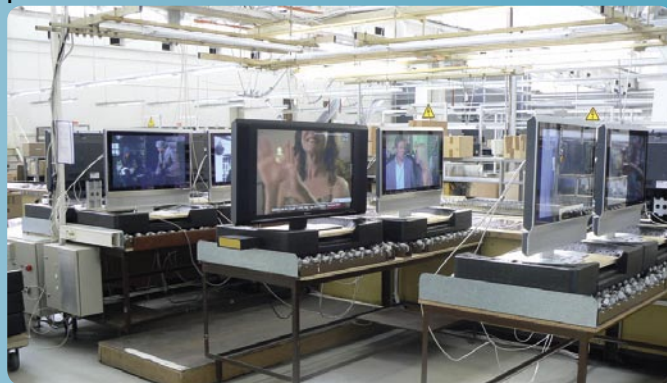
▲ Après la pose des haut-parleurs, le téléviseur à écran LCD est prêt pour l'expédition. Quelques unités sont prélevées au hasard de la ligne de production et posées sur des bancs d'essai pour des séries de tests à longue haleine.
