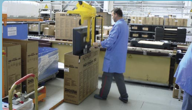
▲ L'étape terminale : Une grue est mise en œuvre pour placer le produit fini dans son carton d'expédition – et tout est prêt !
