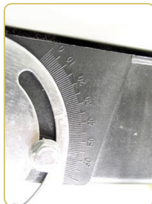
Echelle d'élévation mal lisible
