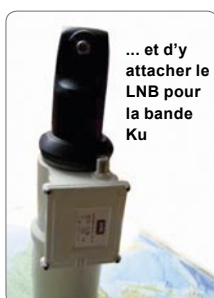
D'abord on enlève le capuchon de protection du LNB pour la bande Ku
