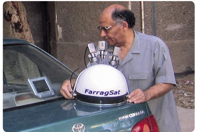
Le Dr. Farrag en train de régler son invention - comme antenne intégrale. Grâce à un émetteur vidéo intégré on peut se passer de câbles pour la connexion de l'antenne avec le téléviseur à l'intérieur de la voiture.
