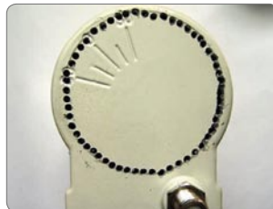
Ensuite il faut percer un tas de petits trous tout autour du bord sur le fond du cornet de la bande C
