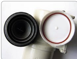
D'abord on enlève le capuchon de protection du LNB pour la bande Ku
