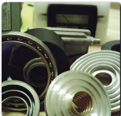
Le LNB et le cornet sont munis de roulements à bille, si vous êtes capables de tourner vous-mêmes vous êtes gagnant
