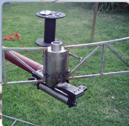
La partie centrale de l'antenne avec les 18 fixations espacées de 20°
