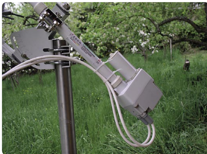
Ce vérin motorisé déplace le support d'antenne
