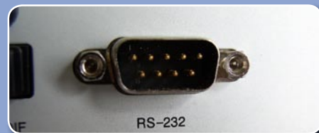
Se trouve sur de nombreux récepteurs: Interface RS232 pour la programmation via le PC
