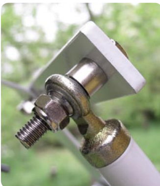
L'accouplement du bras de force est conçu comme palier à friction
