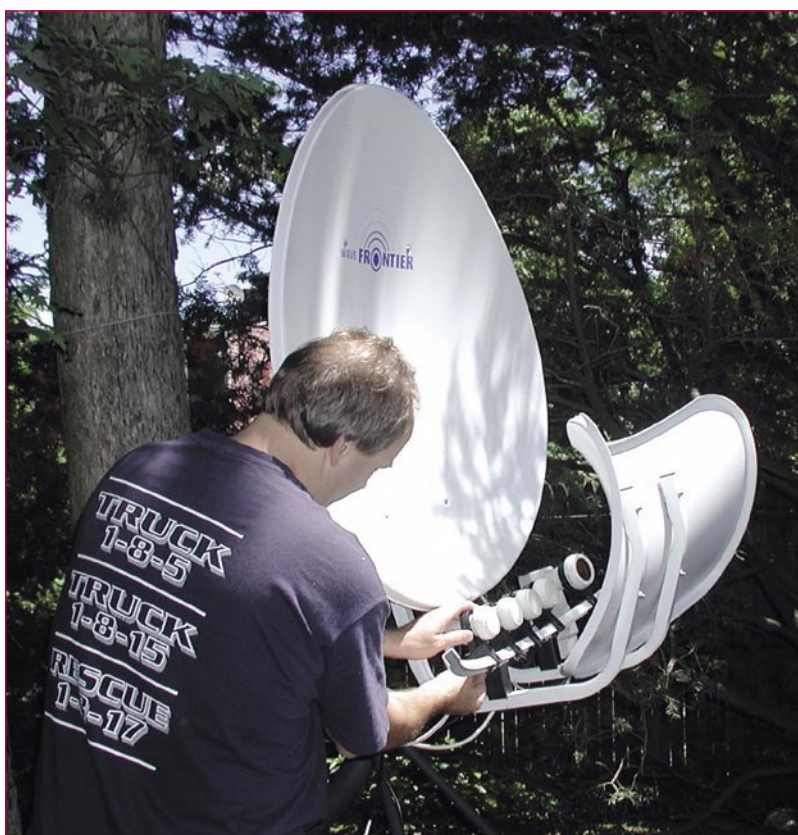
L'éditeur de Satellite International Ron Roessel en train de monter des LNB sur le rail d'une antenne à sources multiples WaveFrontier Toroïdal T90 dans le centre des essais dans la périphérie de New York.
