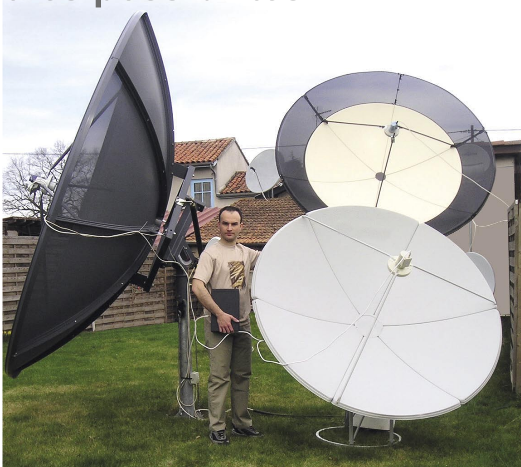
Sylvain Oscul en train d'ajuster sa parabole Prime Focus de 1,80m. Il peut vérifier le signal grâce aux autres paraboles de 2,40 m et 3,10 m.
