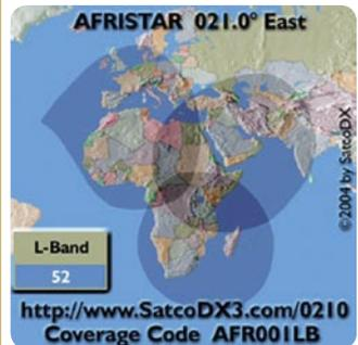
En effet, vous avez la possibilité de continuer à recevoir au Madagascar les émissions de RFI en utilisant un récepteur radio par satellite Worldspace (détails et abonnements à consulter sur [www.worldspace.fr](http://www.worldspace.fr)) ; le signal est transmis par Afristar 3 par 21° Est en bande L.
