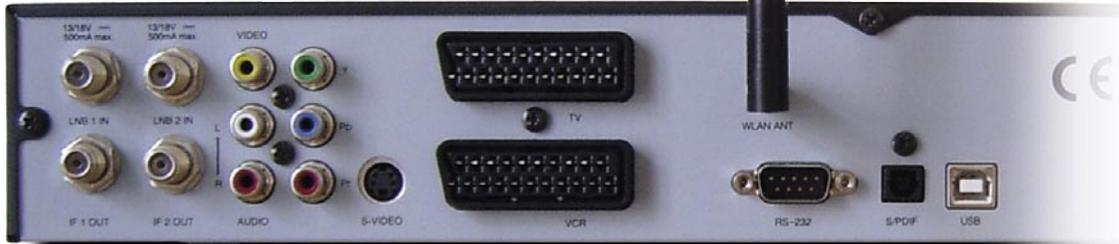
au point la communication de ce récepteur avec un routeur WLAN ou un point d'accès sans fil. Les divers protocoles comme l'ETSI, le FCC ou le MKK sont reconnus ainsi que les taux de transmission de 1 à 54 Mbps. Si nécessaire, le protocole WEP pourra être utilisé pour réaliser un cryptage efficace des communications.
