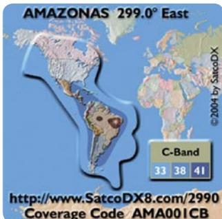
Une antenne de 24 pouces n'est probablement pas assez grande. Pour ces satellites, vous seriez certainement mieux servi avec une parabole de 90 – 100 cm. TV CIDADE sur Amazonas est un signal en bande C en ne peut pas être capté avec une parabole pour la bande Ku. Il vous faudrait une parabole beaucoup plus grande pour pouvoir capter cette chaîne (diamètre de 10 – 12 pieds).
