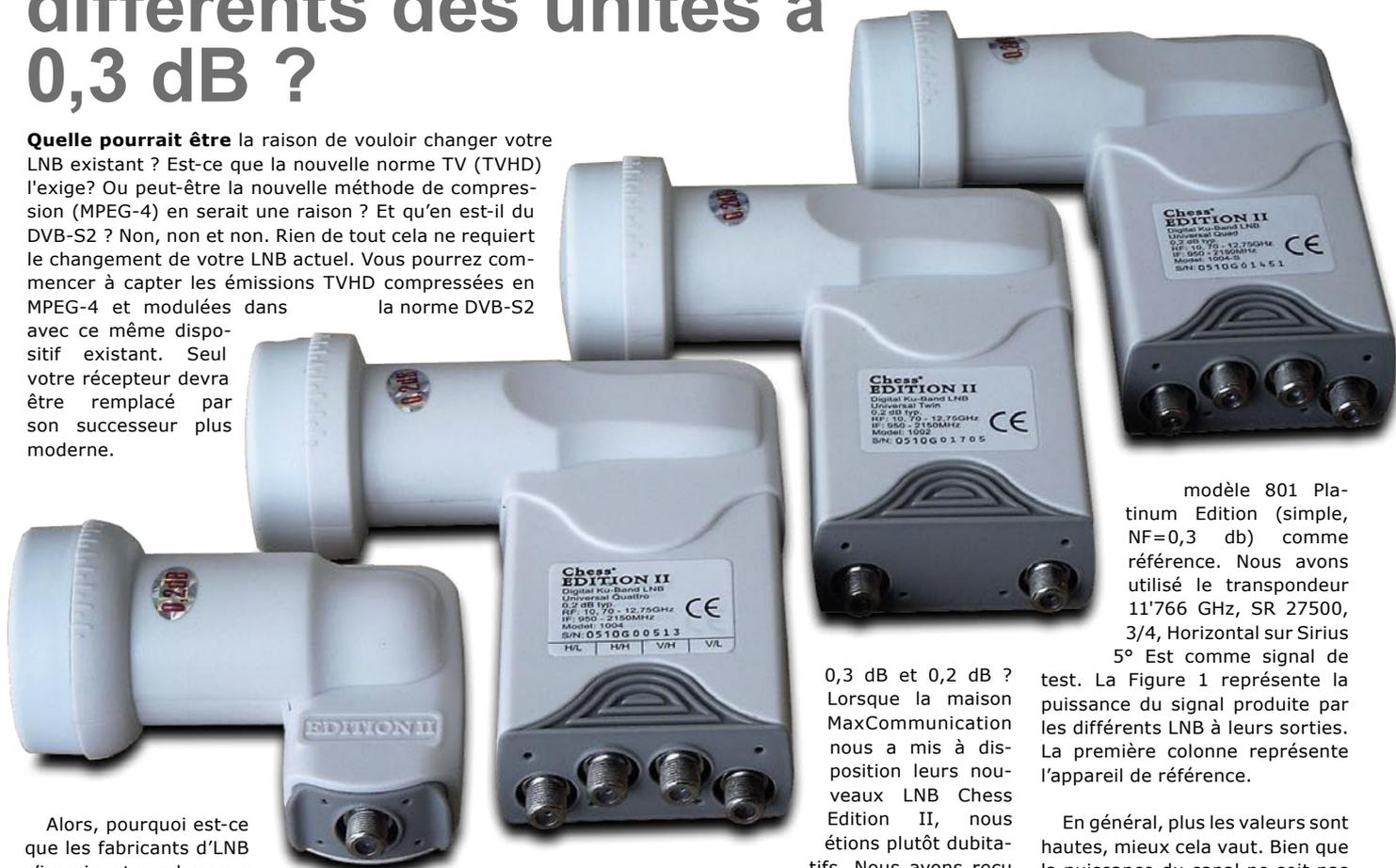
Alors, pourquoi est-ce que les fabricants d'LNB s'imaginent que les gens voudront remplacer leurs vieux LNB avec des modèles plus modernes ? Mise à part les dysfonctionnements du matériel, il n'y a qu'une seule raison à cela, - les nouveaux modèles affichent un facteur de bruit plus bas. Tout appareil électronique, outre la fonction pour laquelle il a été conçu, introduit des parasites dans le signal.
