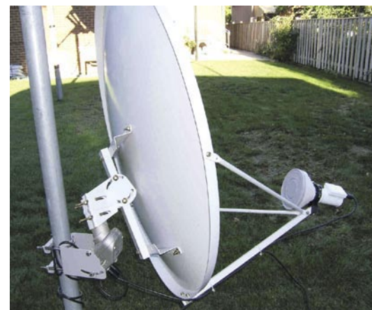
La parabole d'un mètre sur un moteur STAB HH 100 |
