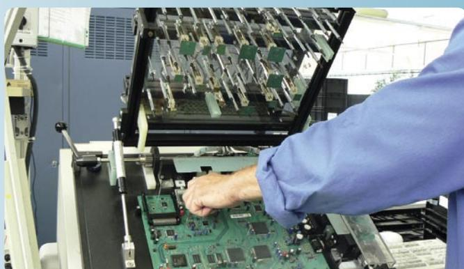
▲ Тук се тества функционалността на дънните платки. След затваряне на капака, тест-пробите правят контакт с определени точки от платките, с което се тестват всички възможни електронни функции.
