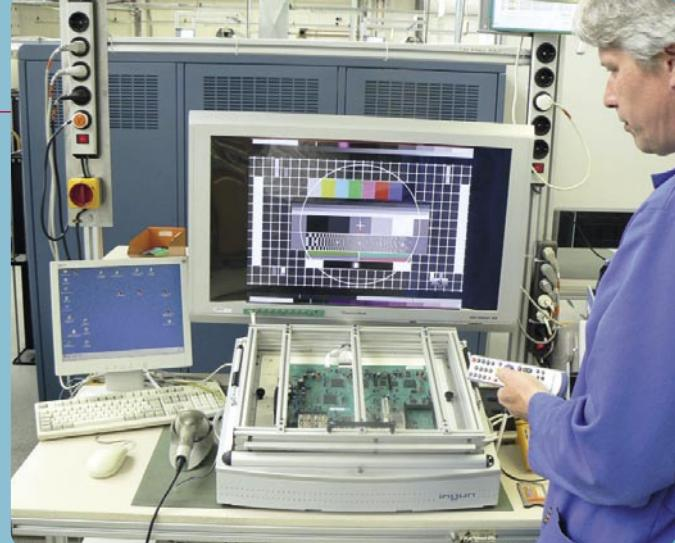
▲ Frank Lehmann е един от техниците, проверяващи дънната платка. Тя е свързана с станцията за тестване на LCD телевизорите с плосък еcran и след свързване на всички антennи връзки се извършва тестване със стандартно дистанционно на всяка функция в реална употреба.
