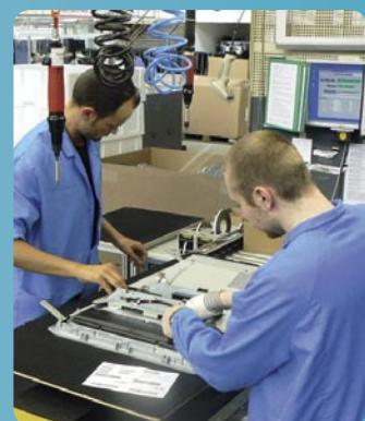
▲ Дънната платка се поставя върху LCD панела и се закрепва с винтове.
