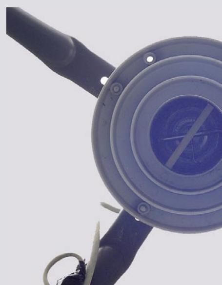
▲ Поглед във вътрешността на въlnовода: ясно се вижда диелектричната пластинка, необходима за приемане на сигнали с кръгова поляризация. След отстраняването ѝ - получавате линейна поляризация.
